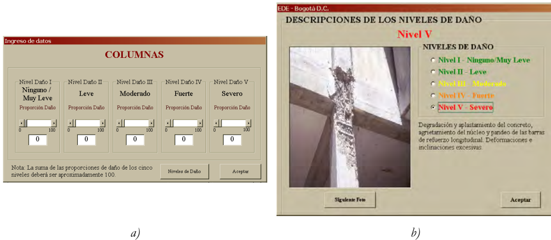
Figura 5.11. Calificación de un elemento estructural: a) Extensión de cada nivel de daño; b) Descripciones y fotografías que ayudan a identificar cada nivel
